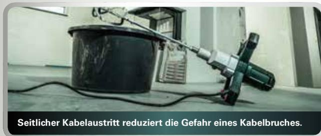
Seitlicher Kabelaustritt reduziert die Gefahr eines Kabelbruches.
