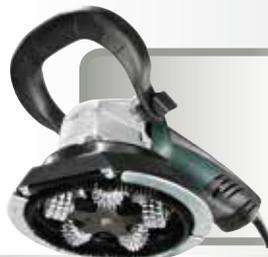
Der gefederte Bürstenkranz an der Schutzhaube passt sich jeder Oberfläche an und liefert so optimale Absaugergebnisse. Durch die Federung bleiben die Bürsten in ihrer Form stabil. Die Folge: eine längere Lebensdauer des Bürstenkranzes.
