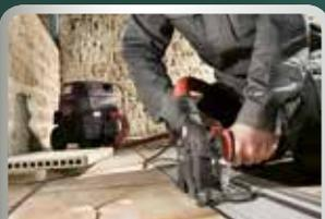
Mit Führungsschiene für schonendes Arbeiten auf empfindlichen Oberflächen.
